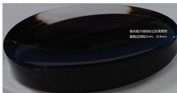
图六 3: 偏光镜片轴线标记处需预留割边损耗 2mm, 计 4mm。
